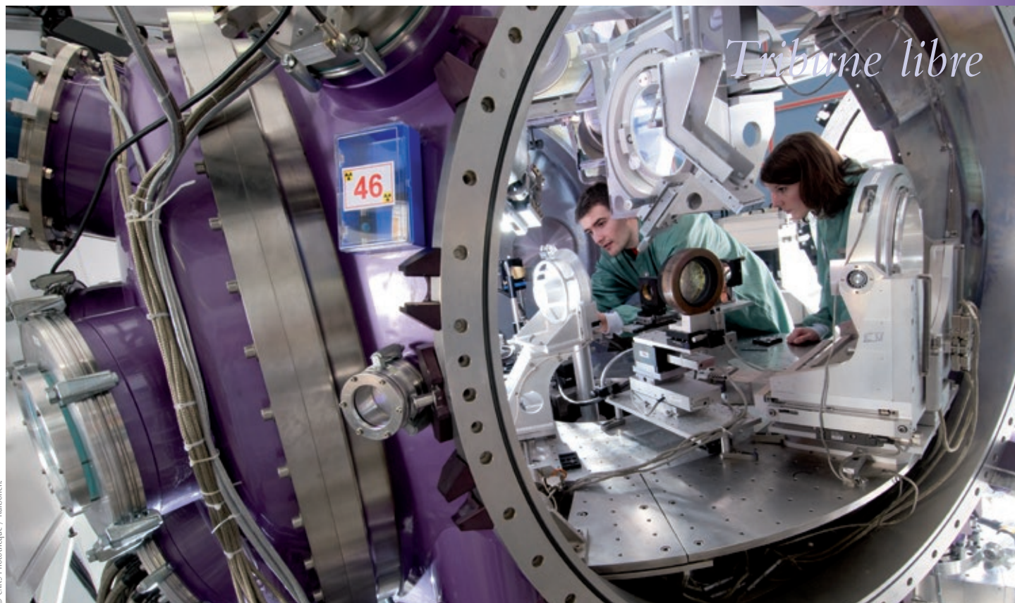
Alignement de cible et mise en place de diagnostics par deux jeunes chercheurs dans la salle d'expérience de l'installation laser de puissance LULI2000, à Palaiseau.
